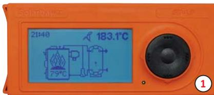
Grafisch animiertes Display mit vordefiniertem Solarbayer-Hydraulikschema. Abgastemperatur-, Kesseltemperatur- und Speichertemperaturüberwachung. Bei Version „HVS Lambda Control“ ist zusätzlich die Funktion „Lambdaregelung“ aktiv.
