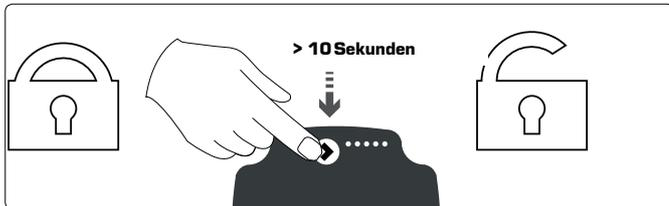
Um die Tastensperre zu aktivieren / deaktivieren, drücken Sie den Knopf mindestens 10 Sekunden. Das Aktivieren / Deaktivieren der Tastensperre wird durch das Aufleuchten aller LEDs für eine Sekunde quittiert.
