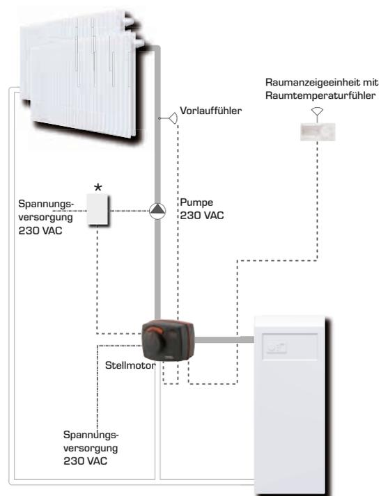
\* Nur für CRB114, Regler mit Kabelkasten Pumpensteuerung
