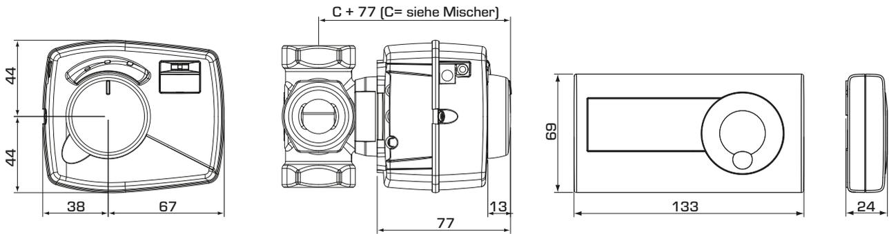
Einbauabmessungen für Reglermodellreihe CRB100 mit VRG100, VRG200, VRG300, VRH100 und VRB100 Mischern von ESBE
