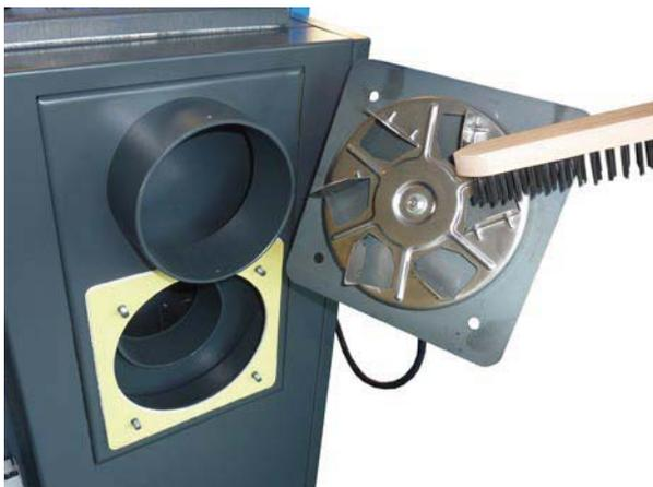
Die Reinigung des Umlaufrad und die Kontrolle des Schaufels bei Saugzugventilator
