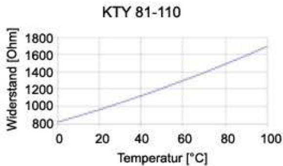
Abbildung 9: Fühler-Widerstand in Abhängigkeit von der Temperatur
