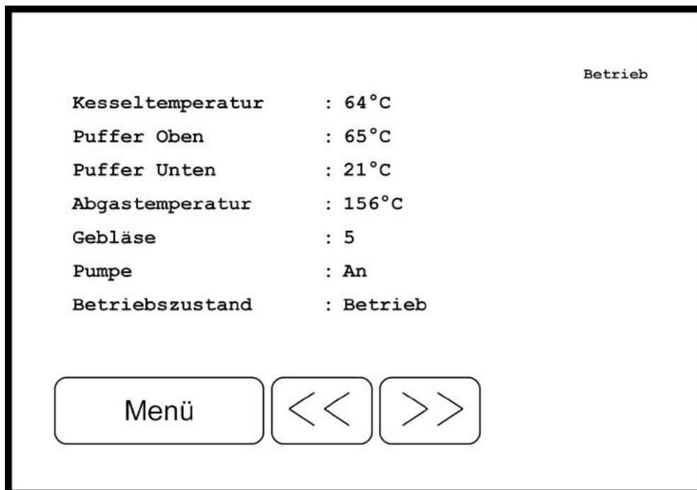
Abbildung 3: Der Standardbildschirm (hier: Kessel- Ist- Werte)
