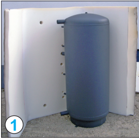
Isolierung ausschließlich in warmen Zustand anbringen. 24 Stunden auf mindestens 22 °C vorwärmen.
