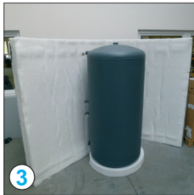
Isoliermantel dem Speicher anlegen und die Speichermuffen exakt durch die vorgestanzt Löcher führen (bei den ungenutzten Ausstattungen sollten die Schaum-Stopfen nicht entfernt werden!)
