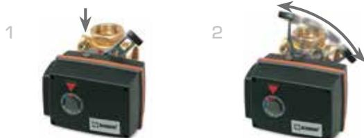
1 Drücken Sie zum Handbetrieb den Knopf auf der Oberseite und verwenden Sie den Handhebel. Der Stromkreis ist unterbrochen, solange der Knopf eingedrückt ist.
