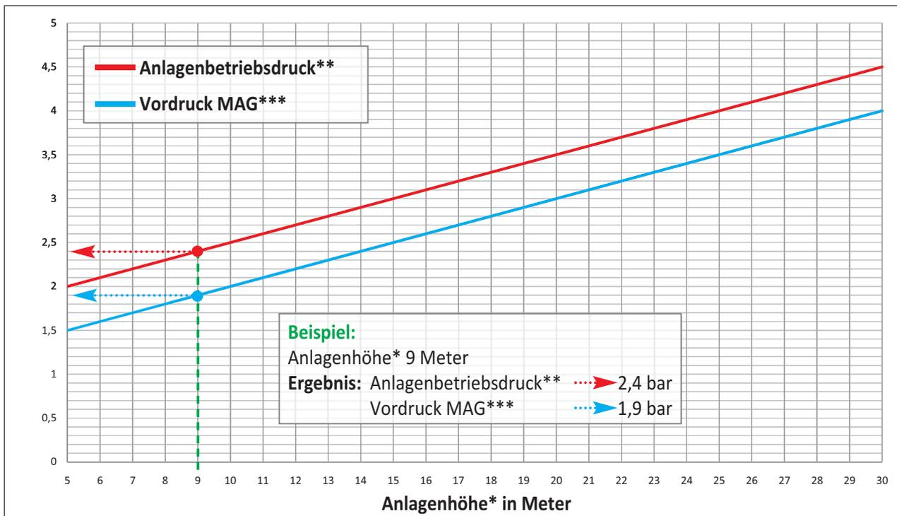
\* Anlagenhöhe ist die gemessene Höhe vom Manometer der Pumpenstation bis zur höchsten Stelle im Kollektorfeld
