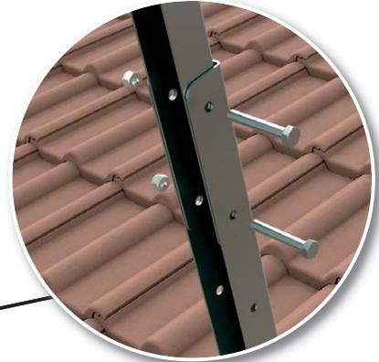
Teleskop-U-Profile zur Einstellung der Kollektorneigung. Soll der Kollektor schwächer geneigt werden, können die U-Profile ineinander geschoben werden. Zur Sicherung werden zwei Edelstahlschrauben (M8x50) und selbstsichernde Muttern verwendet.
