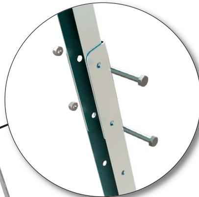
Teleskop-U-Profile zur Einstellung der Kollektorneigung. Zur Sicherung werden zwei Edelstahlschrauben (M8x50) und selbstsichernde Muttern verwendet.
