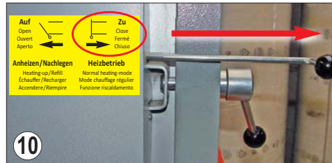
10 Die Zugstange der Rauchgasklappe auf Stellung „ZU“ / „Heizbetrieb“ stellen.
