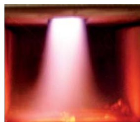
Vollständige Verbrennung der Holzgase in der unteren Brennkammer
