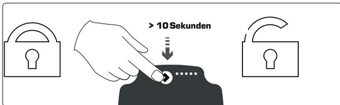
Um die Tastensperre zu aktivieren / deaktivieren, drücken Sie den Knopf mindestens 10 Sekunden. Das Aktivieren / Deaktivieren der Tastensperre wird durch das Aufleuchten aller LEDs für eine Sekunde quittiert.
