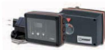
Die ESBE-Modellreihe CRA120 ist ein kombinierter Stellmotor und für die kontinuierliche Überwachung der Durchflusstemperatur in einem Bereich von 5 – 95 °C konzipiert. Empfohlen für Mischer von DN65 bis DN150, besonders geeignet für 3-Wege-Mischermodellreihe F von ESBE.
