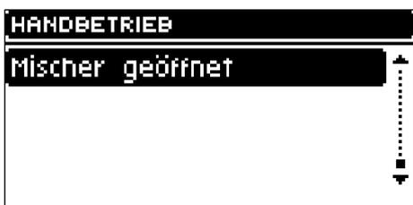
Bei manuellem Mischerbetrieb ohne Außenfühler können sie mit der Taste PLUS und MINUS die Mischerstellung öffnen bzw. schließen.
