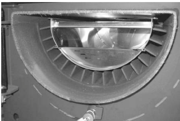
Abbildung 13: richtige Lage der Brennkammerschale
