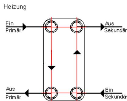
**Typischer Anschluss für Serienschaltung zur Erhöhung der thermischen Länge**
