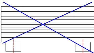
Stellen Sie sicher, dass keine Vibrationen und/oder Pulsationen auf den Wärmetauscher einwirken können.
