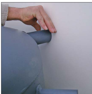
1 Isolierung ausschließlich in warmen Zustand anbringen. 24 Stunden auf mindestens 22 °C vorwärmen.
