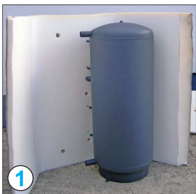
1 Isolierung ausschließlich in warmen Zustand anbringen. 24 Stunden auf mindestens 22 °C vorwärmen.
