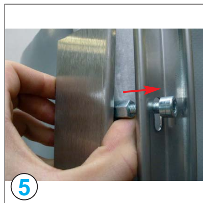
5 Die Innensechskantschrauben der Edelstahl-Verschlusschiene von links durch die Schlüssellöcher in der rechten Schiene führen und nach unten einrasten lassen.
