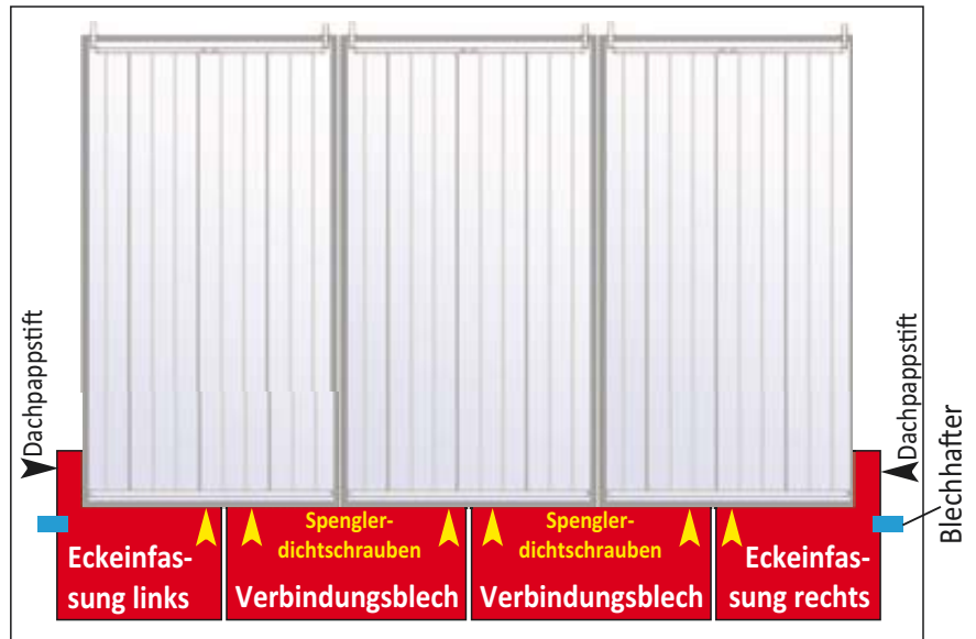
Verbindungsblech (Das Verbindungsblech ist erst bei zwei und mehr Kollektoren in Reihe erforderlich)
