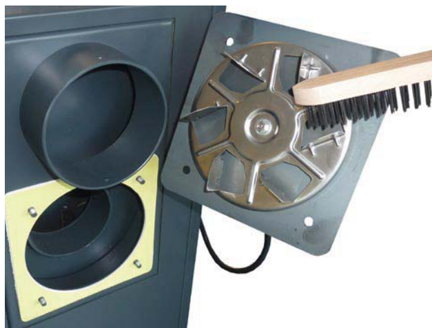
Die Reinigung des Umlauftrad und die Kontrolle des Schaufels bei Saugzugventilator (bei P31)
