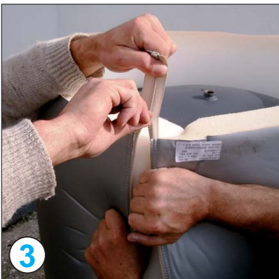
Vorsicht beim Zuziehen (Einreißgefahr bei kaltem Zustand) Keine Zange oder sonstiges Werkzeug verwenden.
