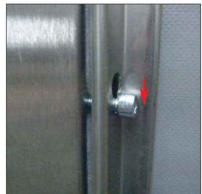
5 Die Innensechskantschrauben der Edelstahl-Verschlusschiene von links durch die Schlüssellöcher in der rechten Schiene führen und nach unten einrasten lassen.
