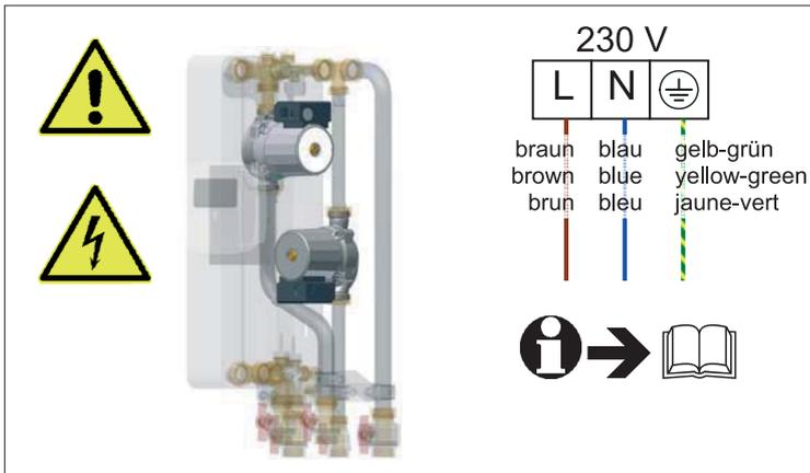
Alle Montage- und Verdrahtungsarbeiten an elektrischen und elektronischen Komponenten dürfen nur im spannungslosen Zustand ausgeführt werden. Der Anschluss und die Inbetriebnahme der Komponenten dürfen nur von fachkundigem Personal vorgenommen werden. Dabei sind die geltenden nationalen und örtlichen Sicherheitsbestimmungen einzuhalten.
